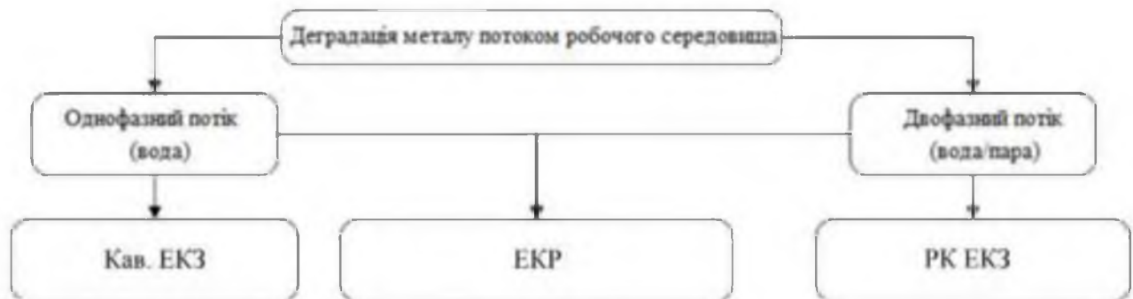
Рисунок Б.2 – Механізми ерозійно-корозійної деградації металу трубопроводів
